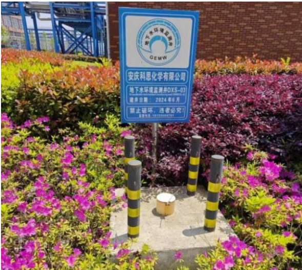
地下水监测井
