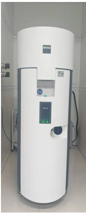
绝热加速量热仪 -ARC
